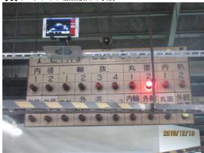
実証実験を開始してから約 2 年が経過したが、この間、操作性や拡張性を高めるために、iPod よりも大きいタブレット端末に変更し、アプリも改良版を開発した。また、異常停止が発生した工程や時刻などをデジタルデータとして蓄積し、過去の発生頻度をパレート図により可視化することで、予知保守に活用している。加えて、通常のラインからは離れて設置され、目視でランプ点灯を確認することが難しい検査機のシグナルタワーの点灯状況も検知できるようにした。
