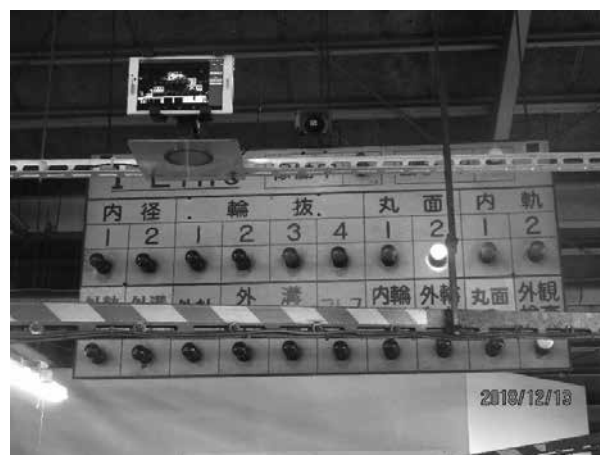
写真1 アンドン点滅検知の状況
