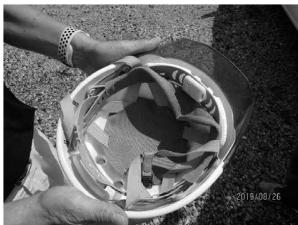
写真2 ヘルメットに小型化したIoTデバイスを装着
